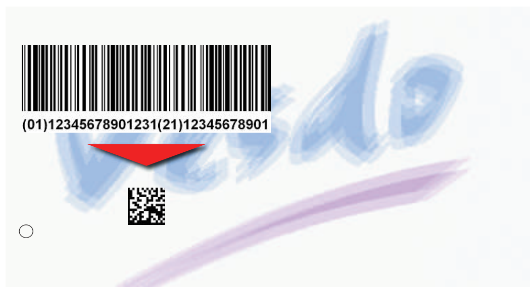
← Data-Matrix-Codes benötigen zehnmal weniger Platz gegenüber konventionellen Strichcodes (Bild: Vesdo)
